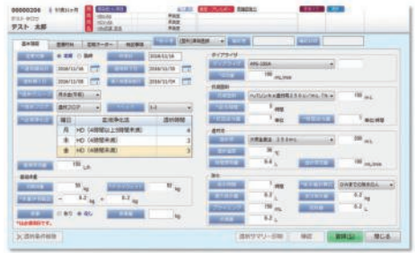
透析条件入力画面。患者の透析情報を登録し、透析室スタッフへ指示。登録したマスタの設定によってダイアライザの機種や抗凝固剤、透析液などを選択し、除水量を設定する。
