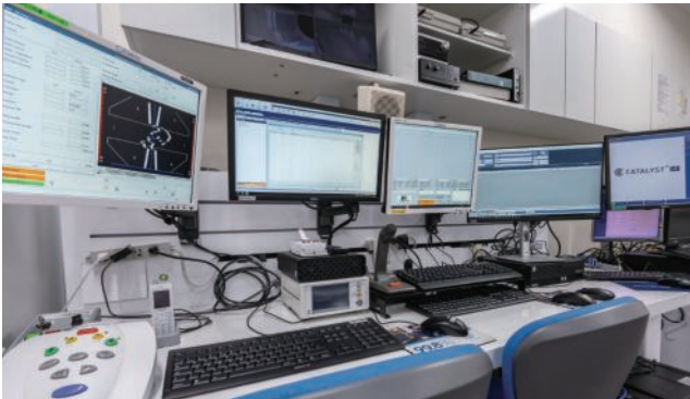
リニアック「Harmony」の操作卓。「Versa HD」とビームマッチングすることで、故障時や緊急照射の際、リニアックを変更しての照射が可能となっている。
