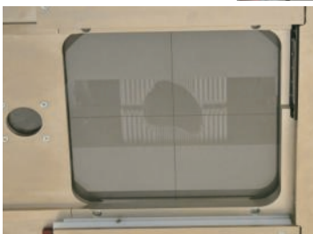
「TrueBeam HyperSight」のMLC (マルチリーフコリメータ)。照射の中心位置精度は装置受け入れ時の検証では0.5 mm以下と従来装置より高い精度の性能を有しており、高品質な放射線治療の提供に貢献している。
