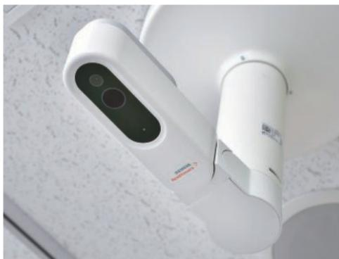
天井部に設置されたFAST 3D Camera。患者の体型、位置、身長を3次元でキャプチャし、寝台の高さを自動で調整。CT検査の効率化に貢献している。
