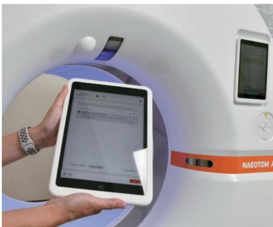
「NAEOTOM Alpha」にはタブレット型操作端末が付属しており、検査室を出ることなく、CTを操作でき、検査時間ギリギリまで患者の傍で検査準備が可能である。
