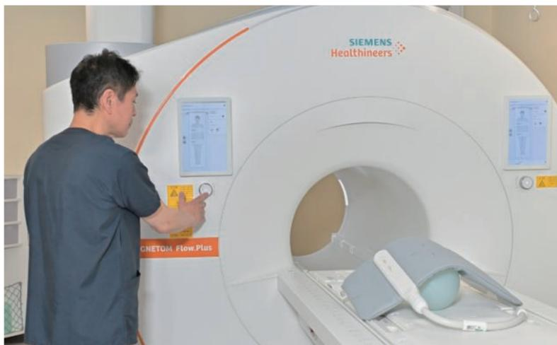
「BioMatrix Contour Coils」には「BioMatrix Position Sensor」が内蔵され、GPSのようなセンサーでCoil位置を自動検出。従来のレーザーライトによる設定をスキップできるため、検査前の準備時間を短縮しながら再現性の高い検査を実施できる。
