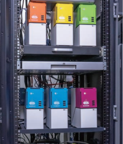
クラウドPACS『NOBORI』のゲートウェイPC『CUBE』。院内で生成された画像データをクラウド上にアップロードする。また、1台の『CUBE』につき500GBの容量を有しており、診療に必要なサーバをクラウド上からダウンロードして保存、各端末への高速配信を行っている。
