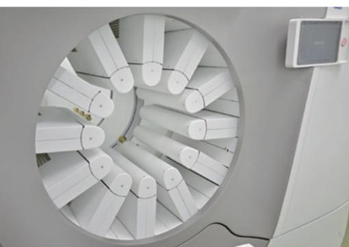
「VERITON-CT」では、3次元人体形状を念頭に装置を設計。12個の独立した検出器を被検者と身体わずか数mmまで近接させることができ、従来装置に比べて大幅に画質が向上している。
