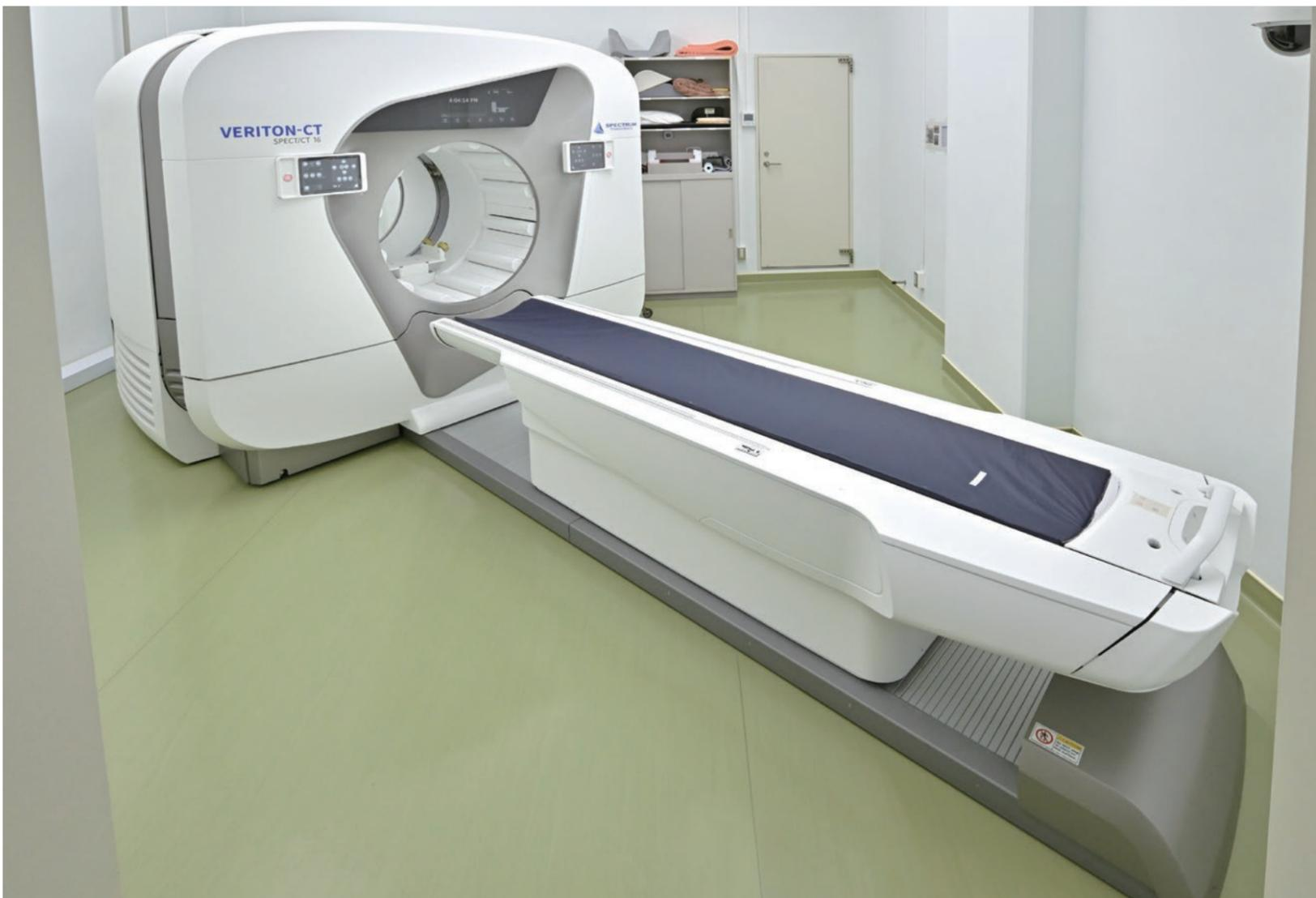
2021年8月に導入された全身用半導体ガンマカメラシステム「VERITON-CT」。同装置は高分解能 CZT 検出器の搭載によって、360度の体輪郭抽出が可能であり、検査のスループットを大幅に向上させるとともに、高品質な画像を提供している。なお、大阪大学医学部附属病院に設置された同装置は、国内1号機となる。
