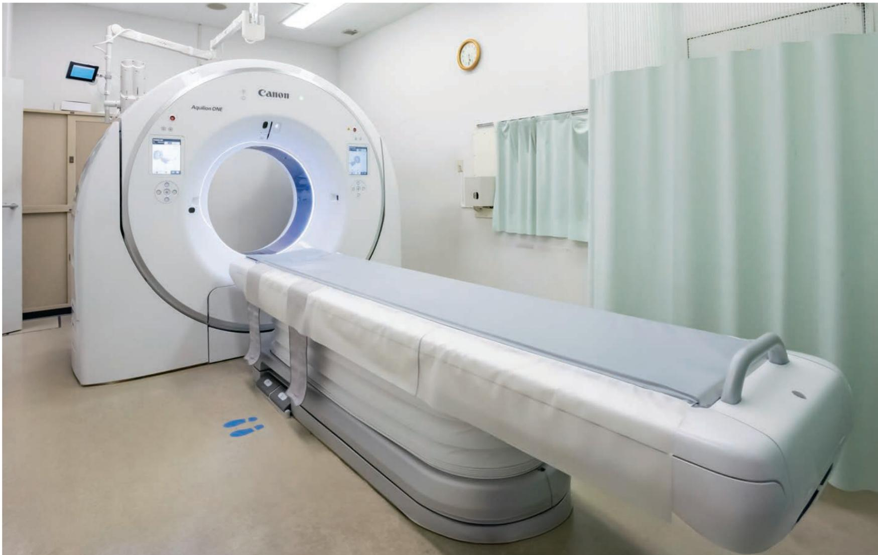
2023年9月に稼働を開始した高精細ADCT「Aquilion ONE / INSIGHT Edition」。1回転0.24秒の高速回転を実現し、さらに新型検出器「PUREINSIGHT Detector（ピュアインサイトディテクター）」と新型X線管「CoolNovus（クールノーヴラス）」を採用した新X線光学系技術「PUREINSIGHT Optics（ピュアインサイトオプティクス）」を搭載。AI技術を活用した超解像画像再構成技術「PIQE（ピーク）」、検査の自動化を推進する技術「INSTINX（インスティンクス）」を装備し、従来のAquilion ONEシリーズの装置を上回る高性能を発揮する。
