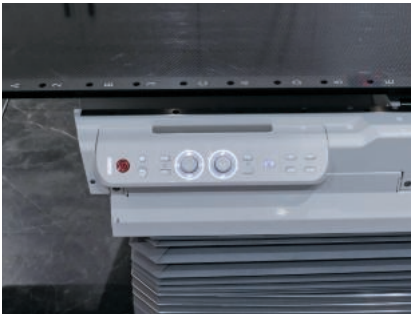
「Harmony」の寝台部分。従来のインターフェイスを一新して、必要な制御と情報を必要な場所に確保し、より患者とセットアップに集中できるように設計されている。
