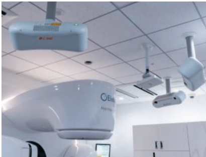
光学式トラッキングシステム「Catalyst HD」。同センターでは、単に位置合わせだけでなく、患者の呼吸状態等の監視にも活用するなどの運用を行っている。
