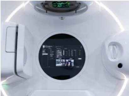
ガントリー部中央にはHUBガントリーパネルを配置。患者情報やセットアップに関する様々な情報が集約されており、患者セットアップをスムーズかつ迅速に行うことができる。
