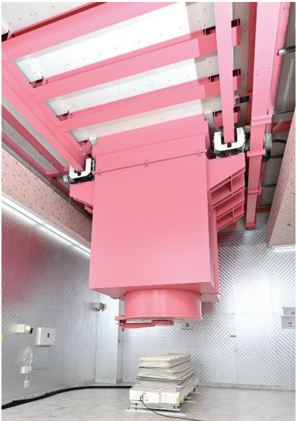
BNCT 装置の照射室。同院で導入している CICS 社の装置では、垂直方向から中性子線を照射するよう設計されており、特定臨床研究の対象である乳房への照射がしやすい機構となっている。
