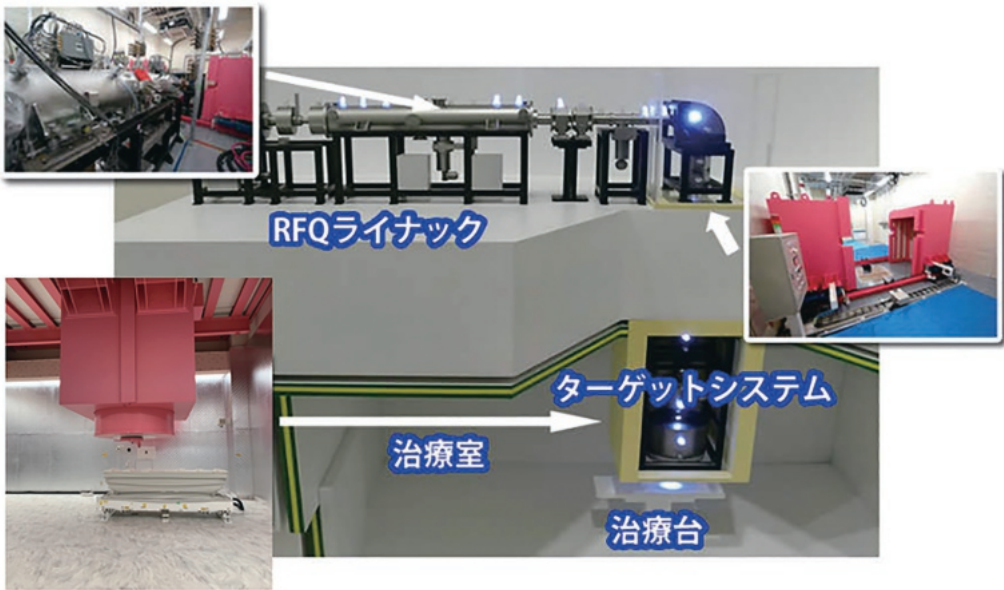
BNCTの構成イメージ。江戸川病院のBNCT装置では、全長7mのRFQライナックで加速された陽子線をターゲットシステム内のリチウムに衝突させて中性子を生成、照射するシステムとなっている。
