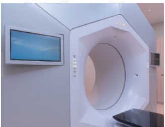
「Halcyon」では、本体にはタッチパネル式の操作が可能なモニターを2面設置。治療室内での簡便な操作性を確保している。
