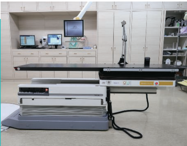
「Novalis Tx」は6軸カウチの寝台を装備。より複雑な形状の腫瘍に対する照射にも対応している。
