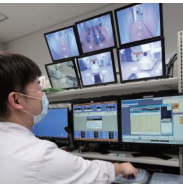
「Novalis Tx」の操作卓。治療計画用ソフトウェア「Eclipse」と連携して複雑な高精度放射線治療を効率的に行うことが可能である。
