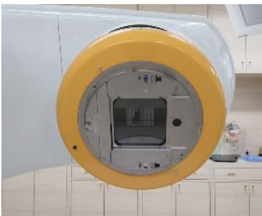
「Novalis Tx」のMLC。照射野は22×40 cmと広く、より大きく、広範囲の腫瘍への照射が可能となっている。
