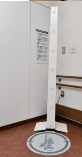
MRI検査室手前に配置された最新型の磁性体検知器「MAGGUARD-S II」。より高感度な超高感度磁気センサシステム「iMus（イムス）」を搭載。ヘアピン等の微小な磁気信号変化から、酸素ボンベなど磁性の大きなものまで、安定した測定を実現する
