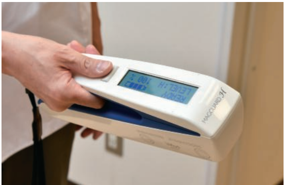
ハンディタイプの磁性体検知器「MAGGUARD-H」。650 gと軽量で扱いやすく、車椅子やストレッチャー等で運ばれてくる被検者に対する磁性体のスクリーニングに威力を発揮。安全・確実な MRI 検査の実施に貢献している
