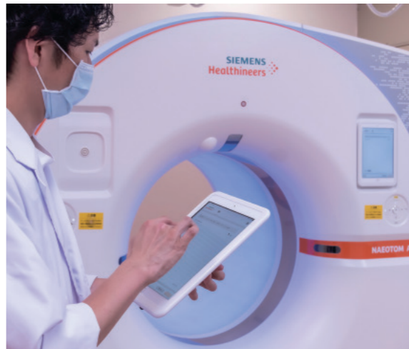
「NAEOTOM Alpha」にはタブレット端末を装備。患者登録から条件設定、セッティング、撮影、画像確認など、一連のCTに関する操作を検査室内で行うことができる。
