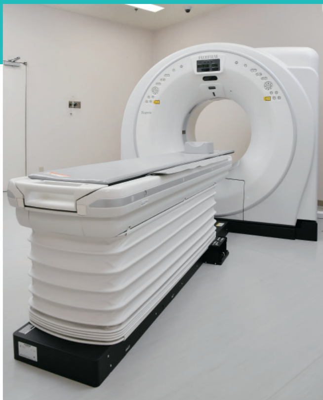
2022年3月に稼働を開始した64列CT「Supria Optica」。コンパクトボディと、AI技術を活用したIPV技術やAI技術を用いて開発したSynergyDrive機能を搭載し、高画質・低被ばく・高効率化を実現している。
