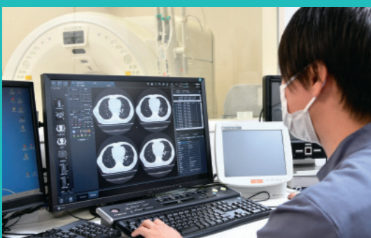
「Supria Optica」を操作する山口氏。操作画面はインターフェースが一新され、操作性が向上。同時に3人分の画像処理も可能となるなど、検査の効率化が進んだと山口氏は語る。
