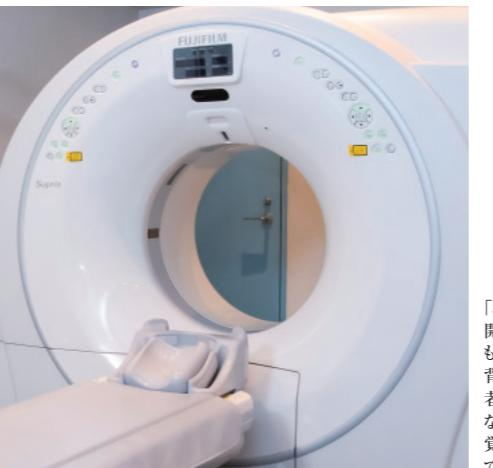
「Supria Optica」は750mmの開口径を有し、腕を上げた検査も余裕をもって撮影が可能。円背などで仰臥位が難しい被検者でも、体位変換が容易。大きな体格の被検者でも圧迫感を覚えにくいなど、さまざまな検査での対応が可能である。
