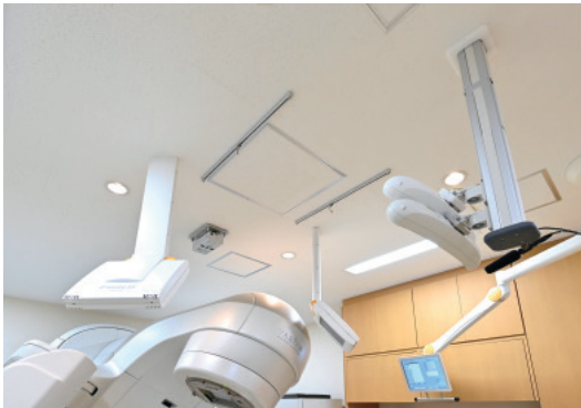
埼玉病院では「TrueBeam」に標準装備されているOBIに加え、モニタリングシステム「ExacTrac (Brainlab 社)」を導入。ミミ満レベルでの高精度な放射線治療を実施している。
