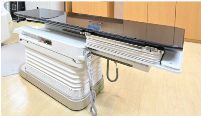
「TrueBeam」に搭載されている6軸カウチ。従来型の4軸カウチと比べ、より細かな動きができ、埼玉病院で実施している広範囲へのIMRTなどを実現可能としている
