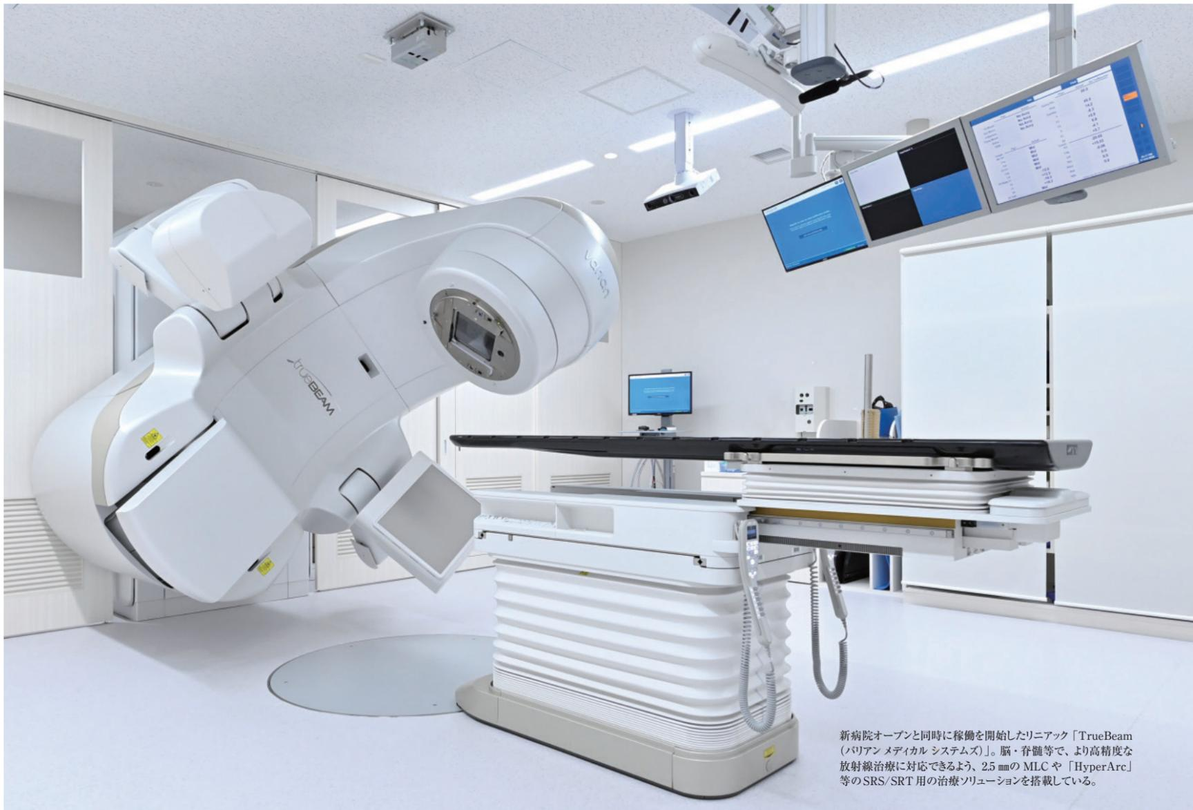
新病院オープンと同時に稼働を開始したリニアック「TrueBeam（バリアン メディカル システムズ）」。脳・脊髄等で、より高精度な放射線治療に対応できるよう、2.5 mmのMLCや「HyperArc」等のSRS/SRT用の治療ソリューションを搭載している。
