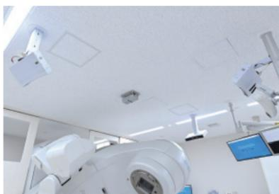
3カ所の高解像度カメラを使用して患者の皮膚表面をスキャンし、三次元的に1mm以下の精度で位置合わせを行うことができる。
