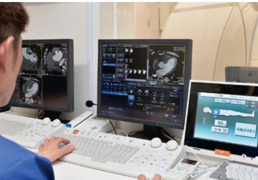
「Aquilion ONE」のコンソールは、操作性が高く、撮影後、画像をすぐに確認できる「Insta View」機能や、撮影範囲をポジショニング時に確認できるエリアファインダ機能など、CT 検査を迅速に行う機能が充実。
