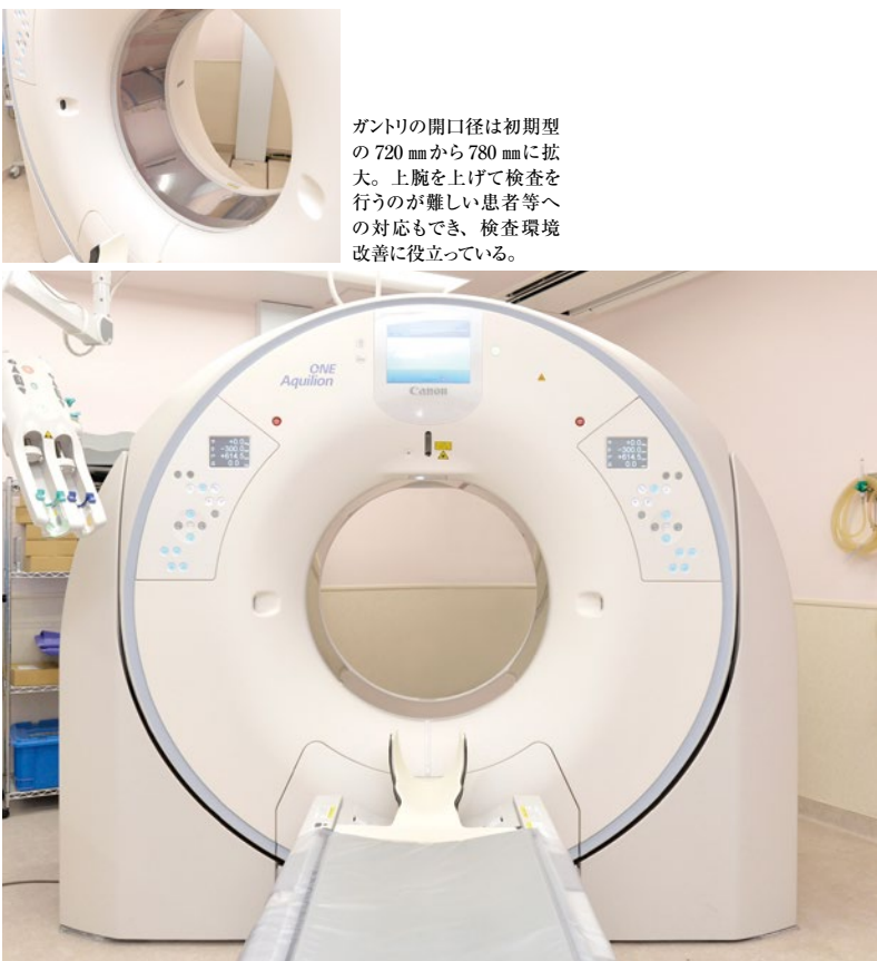
最新型の320列ADCTでは、寝台の左右動が可能となり、コンソールからボタン1つで寝台の上下左右の位置合わせを可能とするSUREPosition機能を搭載。ベッド移動に関する時間が短縮され、膨大な検査数を実施することに貢献している。
