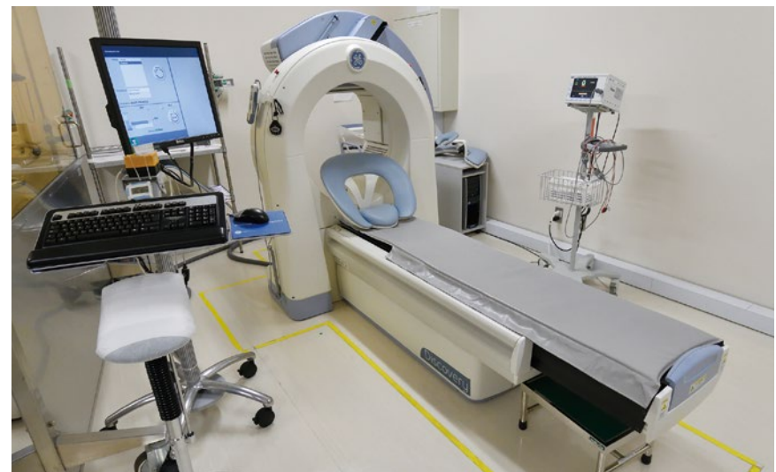
半導体 SPECT 装置「Discovery NM530c (GE)」。CZT (Cadmium-Zinc-Telluride:テルル化亜鉛カドミウム) 半導体検出器とピンホールコリメーターを搭載、従来型装置と比較して空間分解能が2倍、感度が4倍向上している
