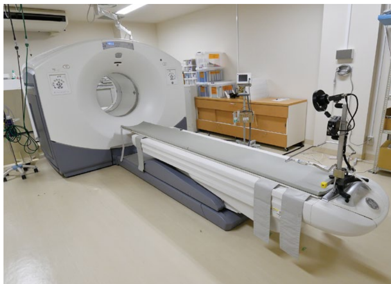
愛媛大学医学部附属病院で稼働中のPET/CT「Discovery PET/CT 600 (GE)」。同院では、デリバリーPETによるFDG-PET検査を実施。呼吸監視装置を設置することで呼吸性移動の問題をクリアするなど、精度の高い画像を描写する
