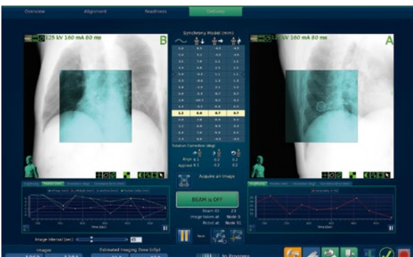
サイバーナイフ治療システムは、呼吸で動く肺腫瘍をコンピューターが認識して追尾照射が可能。照射のための侵襲的な体内マーカー留置が不要であり、大きな呼吸変動がない限り、自由呼吸下での定位照射ができる。
