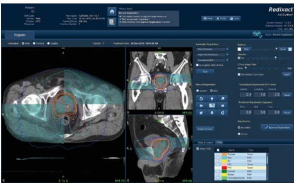
トモセラピー「Radixact」はコーンビームCT撮影を行うことができるため、計画時のCT画像とセットアップ時のCT画像で位置合わせが行える。実際の病変部の確認を照射直前に行う、高い画像誘導性を用いた高精度照射が可能である。
