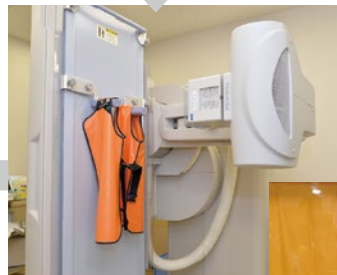
X線TV透視装置でX線防護具内の様子を撮影。タブレット端末で透視画像を撮影し、システムに取り込んで点検記録とリンクさせることができる
