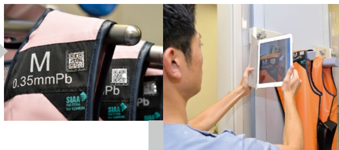
X線防護具に付けられているQRコードをタブレット端末で読み取り、製品情報・点検記録を確認
