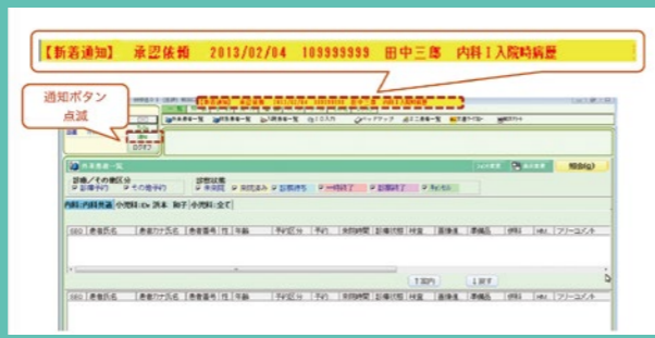
【図1】アラート通知機能における通知メッセージの表示画面。アラート通知は、電子カルテ画面上部に通知メッセージを表示すると同時に通知ボタンが点滅。10秒毎に次の新着メッセージを表示する。メッセージがない場合は、通知メッセージ欄を非表示とする(画像提供協力: NEC)
