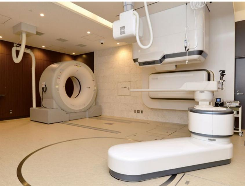
治療室は4室設置されており、全ての部屋に同室CTも併せて設置。ロボットアーム型治療台を用いた「患者位置決めシステム」を採用し、3次元スキャニング法による高精度な重粒子線治療を可能としている
