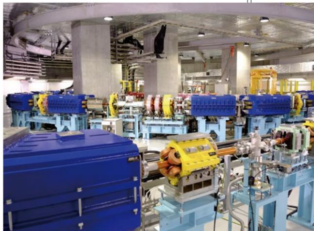
加速器室内には、シンクロトロン（写真上）と入射器／線形加速器を設置。従来装置に比べて大幅に小型化された直径20mの円形加速器で炭素イオンを光の速さの70%まで加速、体内のがん病巣に照射する
