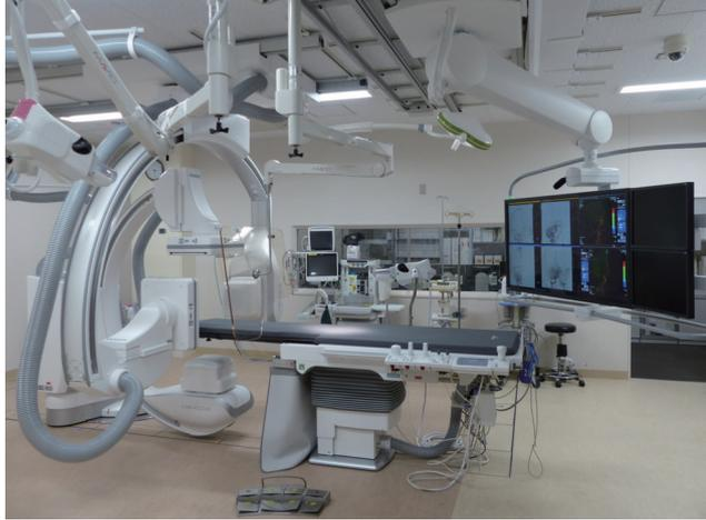
バイプレーン式血管撮影装置「Artis Q Biplane」。バイプレーン型の特長を生かし、主に脳血管内治療に使用している
