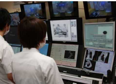
放射線治療システム「Versa HD」の操作室。回転原体照射に強度変調の機能を加えた最先端の照射法である「VMAT」により、より高精度な放射線治療を実施している
