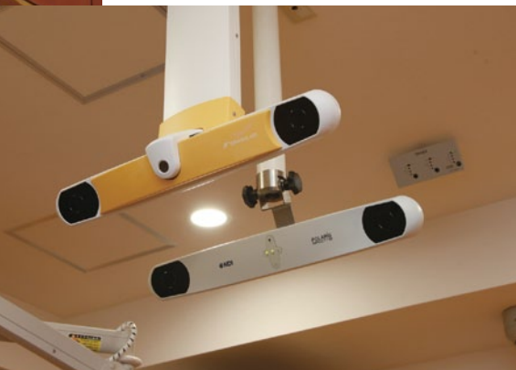
位置決めシステムには、「Versa HD」付属の3次元光学計測システムに加え、赤外線等で位置決めを行うシステムを導入し、高精度な位置決めをより短時間で実施できる体制を実現
