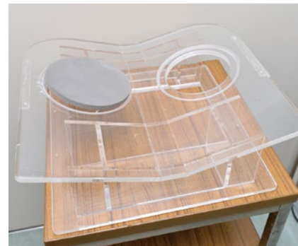
以前使用していた腹臥位乳房治療台。乳房における放射線治療の精度向上と正常組織への被ばく低減のために、福原氏自身が考案・製作した
