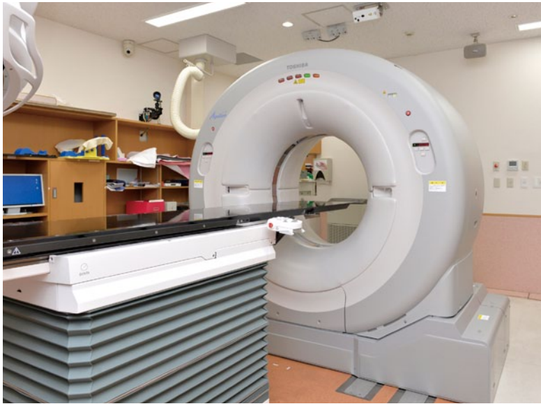
東芝メディカルシステムズ製自走式16列CT「Aquilon LB」。東芝メディカルシステムズとエレクタの共同開発により、治療計画策定時と照射直前のCT画像をフュージョンし、定量解析するソフトウェア（MOSAIC）と遠隔寝台制御の統合が図られている。CT開口径はリニアックと全く同一クリアランスを再現され、従来装置に比べ精度よく効率的に運用できるようになった
