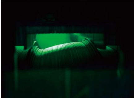
「Elekta Synergy」に搭載されたMLC（マルチリーフコリメータ）。従来装置と比較して、広範囲を、高精度で、短時間に照射することが可能となっている
