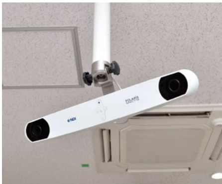
「Elekta Synergy」装備の3次元光学式計測システム。6軸ロボティックカウチ（天板）と連動し、精度の高い位置決めに貢献している
