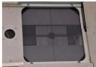
MLC (マルチリーフコリメーター) のリーフ幅は、「TrueBeam」が5 mm、「TrueBeam STx」が2.5 mm。「STx」は脳転移腫瘍など、複雑な形状の腫瘍に対する定位照射で威力を発揮
