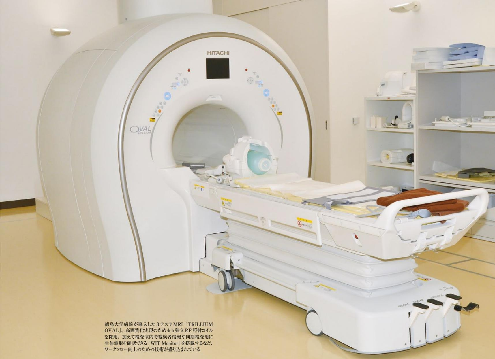
徳島大学病院が導入した3テスラMRI「TRILLIUM OVAL」。高画質化実現のため4ch独立RF照射コイルを採用、加えて検査室内で被検者情報や同期検査用に生体波形を確認できる「WIT Monitor」を搭載するなど、ワークフロー向上のための技術が盛り込まれている
