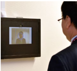
サーバ室には顔認証システムを導入。入退室に関するセキュリティを高めつつ、利便性の高い運用を図っている
