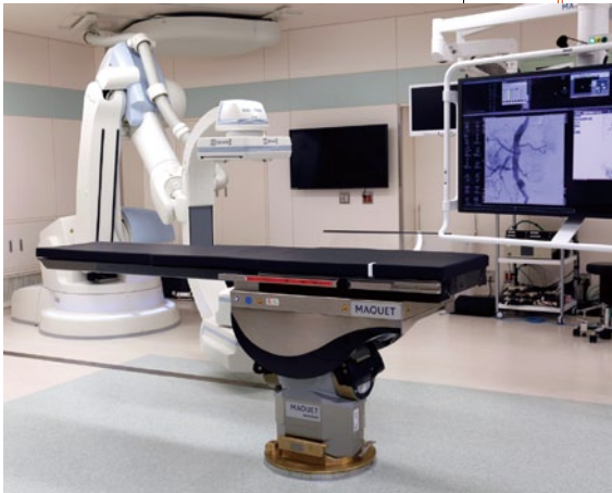
多軸血管撮影装置「Artis zeego」 8 軸関節がもたらすアームポジショ ニング機構が先進的なハイブリッド手術 室の環境構築に威力を発揮。シーメン ス独自の被曝低減プログラム「CARE」 と多彩なアプリケーションを統合した画 像処理エンジン「CLEAR」により、低 被曝と高画質を両立させている
