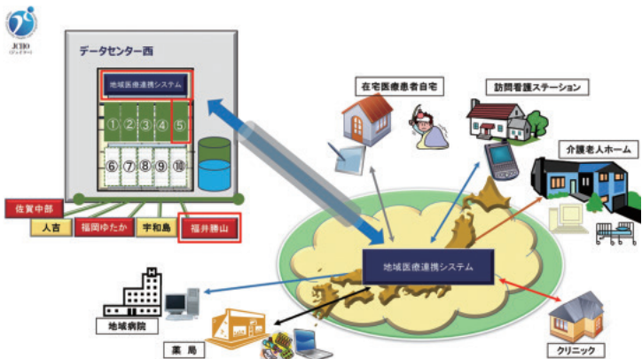
【図3】クラウド仮想サーバ上に地域連携システムとのインターフェース機能を構築し、個別の地域ごとではなく、JCHOとして一本化された地域連携システムとの接続を図る
