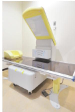
X線骨密度測定装置「DCS-900FX（日立アロカメディカル）」。コンパクトで高出力なX線発生装置を搭載。日立アロカメディカル独自の広角ファンビーム方式を採用。ビームの歪みを抑え、信頼性の高い骨密度測定値を提供している
