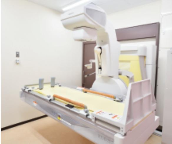
FPD搭載の多目的X線透視撮影装置「EXAVISTA（日立メディコ）」。ドック検診における胃透視検査等に活用。高画質で安定的な検査業務の遂行に貢献
