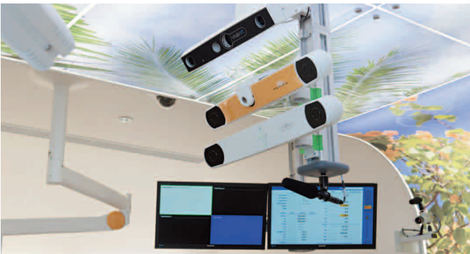
「TrueBeam STx」のセンサ・カメラと位置決めシステム「ExacTrac」およびリアルタイム3次元体表面トラッキングシステム「Align RT」のカメラ。高精度な放射線治療を実現するため、より精度の高い位置決めシステムやトラッキングシステムを採用している
