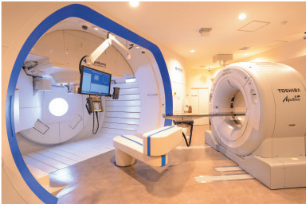
照射室内にあるインルームCT。大口径ボアを持つ16列32スライスのMDCTを導入。治療計画に加え、高分解能が必要な肺や腹骨盤部領域などの実質臓器の照射においては、診断用CTと同等の画質で位置照合を実施する
