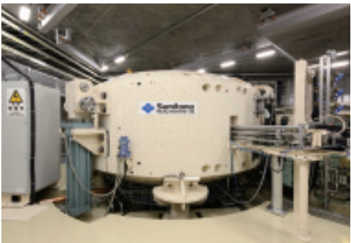
陽子線を発生させるサイクロトロン。他の加速器よりも高強度かつ連続的なビーム特性を持ったため、肺や肝臓等の呼吸性臓器への照射の適応性に優れ、治療時間の短縮や治療回数の低減を実現させる能力を有する
