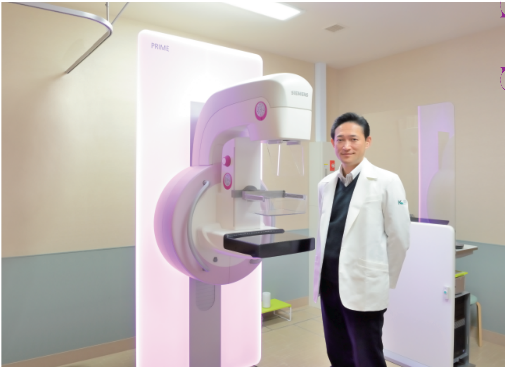
デジタルマンモグラフィ「MAMMOMAT Inspiration（シーメンス）」と戸崎光宏氏。ハイスピードディテクタを搭載した同装置は、快適な検査ワークフローを実現。バイオプシー対応やトモシンセシス撮影といった機能を持ち、最新式の低被ばく技術 PRIME テクノロジーによって、さらなる被ばく低減を実現している
