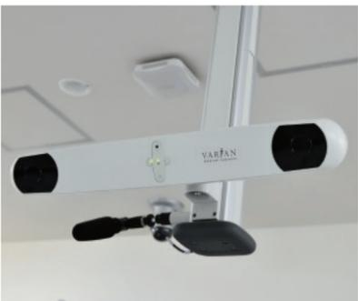
バリアン社のオプティカルイメージャ。SyncTraxと併用することで体動をモニタリングし、正確なゲーティング照射を支援し、低侵襲による動体追跡照射を実現している。
