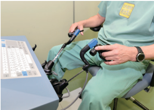
オープンコクピットのハンドル。ハンドル操作は、腹腔鏡下手術と同様のハンドルであり、操作する鉗子等の道具類も自身が使い慣れたものを装備させることができる。
