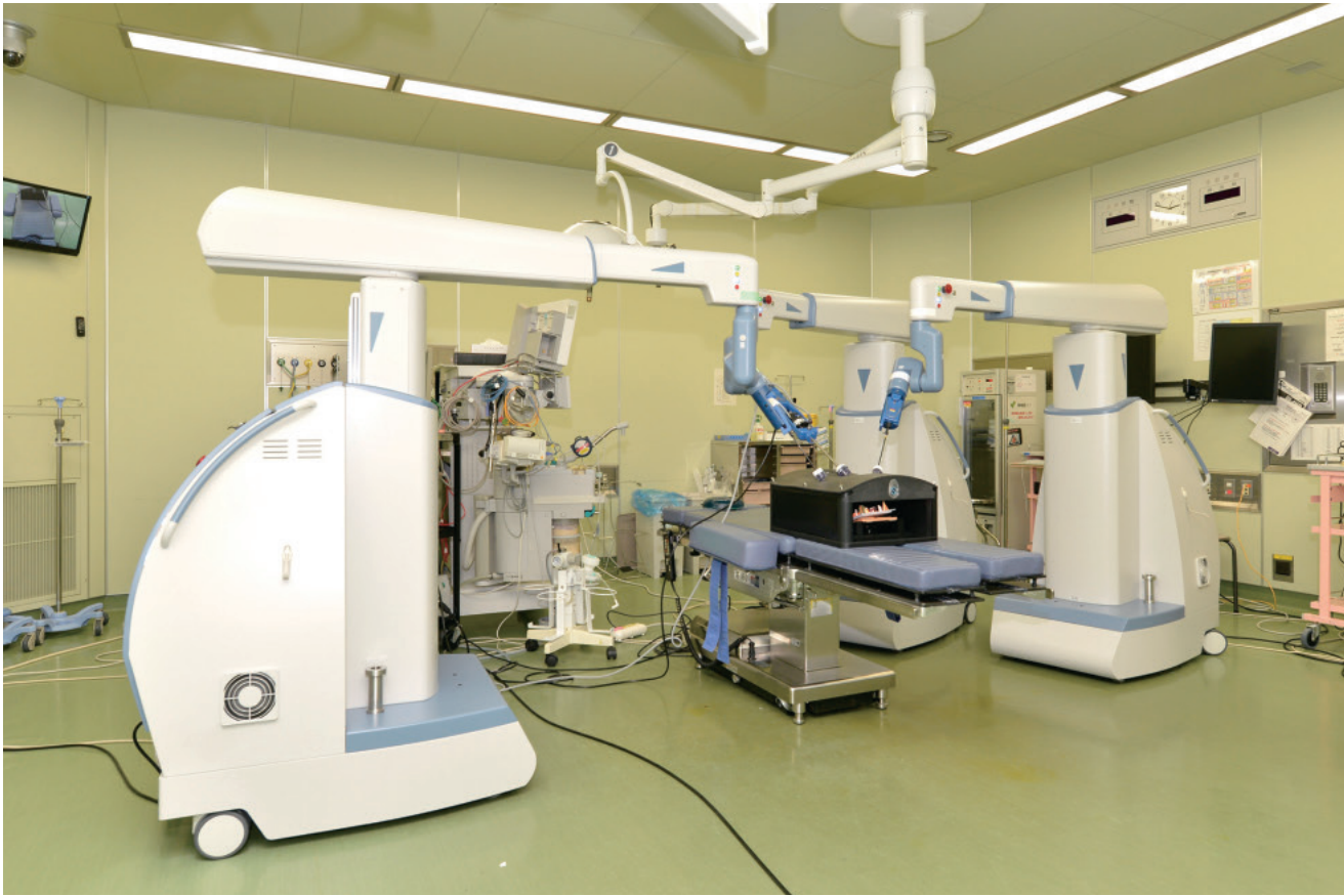
ロボット手術装置「センハンス」。手術装置は3あるいは4つのアームがそれぞれ独立して設置するように設計されており、長いアームによって手術台周辺のスペースを確保。手術室として必要なスペースは、一般的な6m×6mの大きさがあれば問題なく同装置の設置が可能である。
