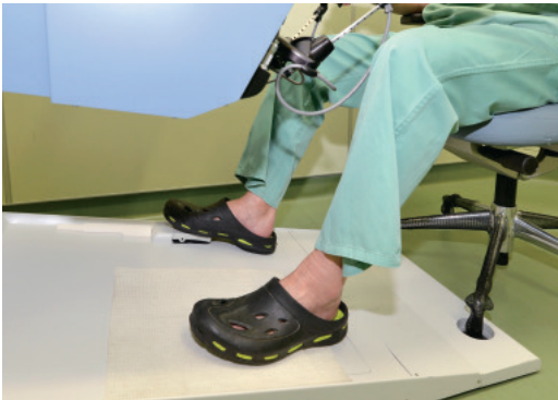
オープンコクピットのペダル部分。「センハンス」は、足でペダルを踏んでいるときのみ動作する。この機能を生かすことで術中の安全確保に役立てることができる。
