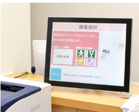
放射線科受付にある自動受付端末。時間外等スタッフの少ない時間帯や、外来混雑時には「2人目」の受付として、検査受付業務の効率化および迅速化を果たしている
