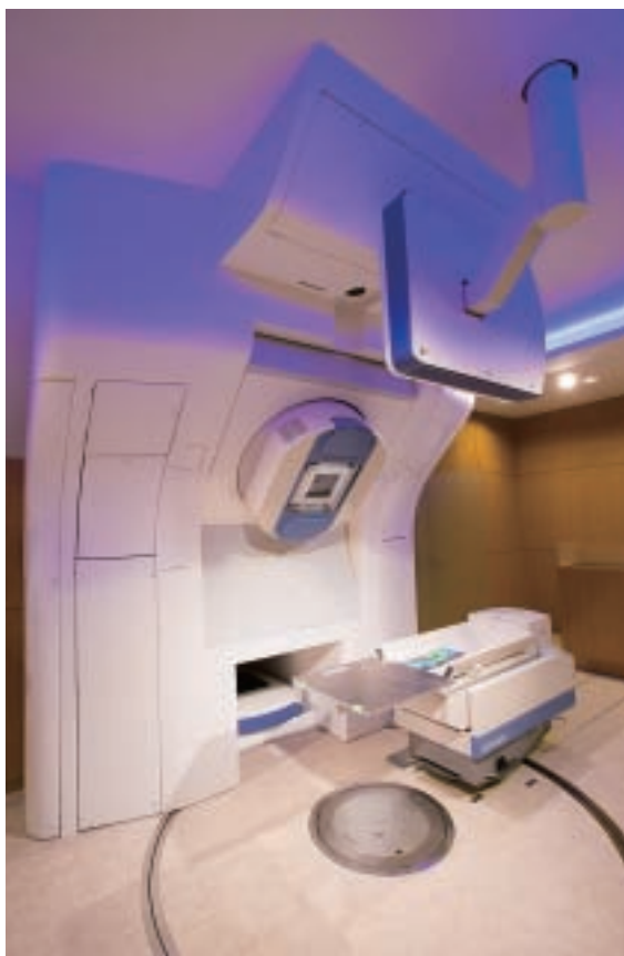
水平・斜め45度方向からのビーム照射が可能な治療室A。45度方向からの照射により、治療の自由度が増すことが期待されている。2014年4月頃を目途に運用を開始する予定
