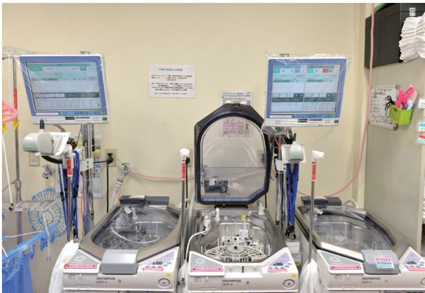
内視鏡洗浄消毒システムと「NEXUS」の洗浄履歴管理端末。使用したスコープの洗浄消毒履歴を、タッチパネルによる入力で、簡単かつ洗浄消毒を実施しながら登録することができる
