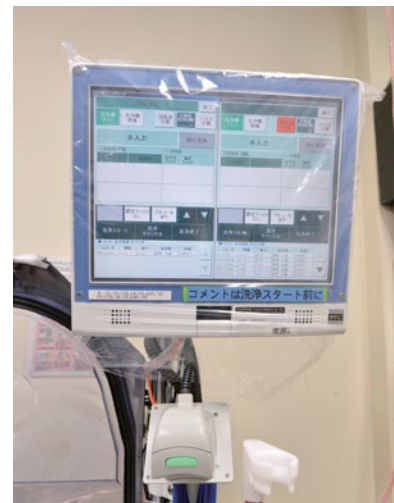
内視鏡洗浄消毒システムと「NEXUS」の洗浄履歴管理端末。使用したスコープの洗浄消毒履歴を、タッチパネルによる入力で、簡単かつ洗浄消毒を実施しながら登録することができる
